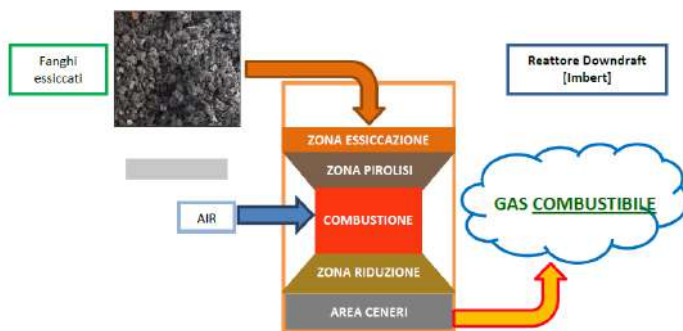
Figura 1. Schema semplificato del processo di conversione termochimica operato da ECOs.
