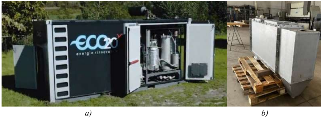
Figura 3. Prototipi realizzati da CMD: a) sistema ibrido containerizzato insonorizzato; b) scambiatore innovativo per la caldaia a gassificazione di biomassa.
